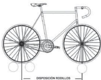
**2)** La distancia desde el punto intermedio entre los dos rodillos posteriores hasta el centro del rodillo anterior ARION, que por comodidad llamaremos "Y" (Fig.3), tendrá que corresponder o aproximarse lo más posible a la medida "X". El eje del rodillo anterior ARION tiene que ser posicionado en el agujero del bastidor ARION, cuya medida escrita en la escala graduada se aproxime
